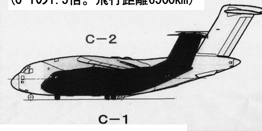
2018年に情報収集機として入間基地に配備予定のC-2飛行機(C-1の1.5倍。飛行距離6500km)
